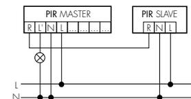
Agrandissement de la zone de détection d'un appareil Master avec des appareils Slave.
